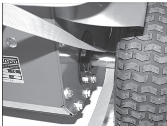
4) L'axe arrière sert de point de fixation
