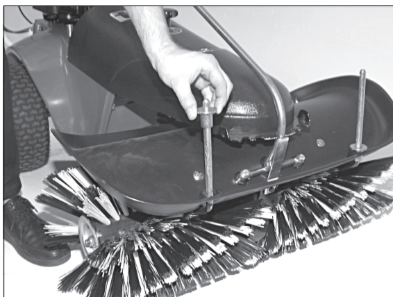
3) Placer les douille sur les tiges de réception de la balayeuse.
