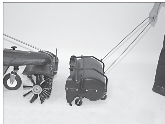
7) Pour vider les balayures dans un autre récipient (brouette p. ex.), retirer complètement le bac à balayures.
