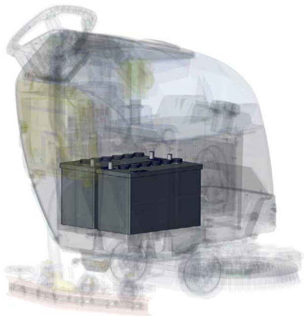
7 - SYSTÈME D'ALIMENTATION À BATTERIE
