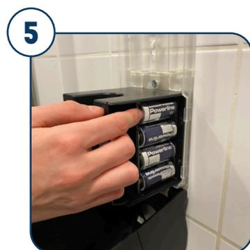
Insérez correctement 4x 710020 -type C dans le compartiment des piles puis refermez-le correct.
