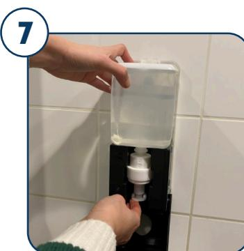
Placez la recharge dans le distributeur avec l'étiquette vers l'arrière.
