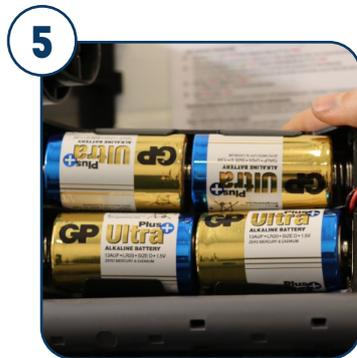
Prenez le compartiment des piles et insérez-y des piles **4x 710021 - D**.
