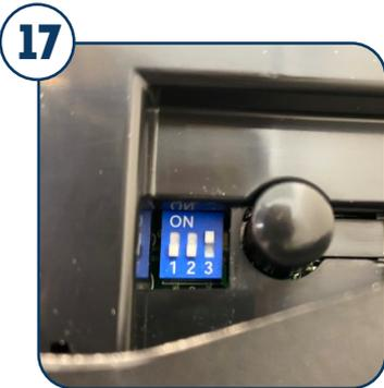
17 Le système de retardement est réglé avec le bouton 3. Si vous laissez le bouton vers le bas, aucun délai n'est défini. En positionnant le bouton vers le haut, vous obtiendrez un délai de 2 secondes.
