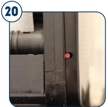
20 Le voyant rouge clignote ? Il est bientôt temps de remplacer les piles. Si le voyant rouge reste allumé, les piles sont vides et le distributeur cessera bientôt de fonctionner.
